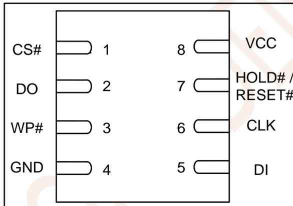
Figure 3.2 DFN8 (5\*6 mm)
