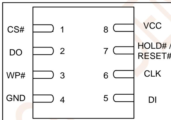
Figure 3.2 DFN8 (5\*6 mm)
